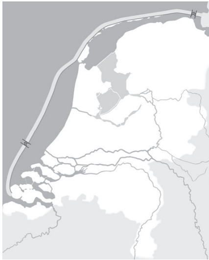
Figuur 37. De vlucht naar voren: bij deze optie komt er tot 30 kilometer uit de kust een dijk die Nederland moet beschermen tegen overstromingen uit zee. [Bron: Vellinga (2008) 42 ]
